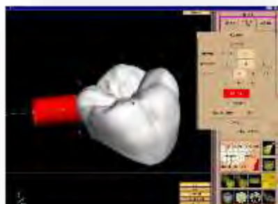
専用のスキャナーで歯型模型を読み込み、歯冠補綴物をデザイン
